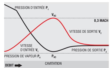
En obligeant le fluide à passer par une série d'angles droits, il peut être contrôlé à chaque étape de détente. Les passages au travers d'angles droits et d'augmentations de section successives, élimine l'énergie cinétique et la vitesse du fluide de façon contrôlée.
