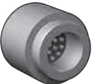
*Le siège de diffusion (DS) est composé d'un certain nombre d'orifices percés à l'intérieur du siège aval. Adapté dans une vanne, la technologie DS offre une excellente solution de régulation à quart de tour peu coûteuse.*
