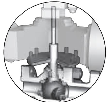
*D'ordinaire, les actionneurs quart de tour sont montés via plusieurs tringleries, ce qui augmente les jeux et réduit la précision. Les vannes FlexStream utilisent un axe monobloc fabriquée sur mesure pour être adaptées directement à l'entraînement de l'actionneur, supprimant ainsi toute déperdition de mouvement.*
