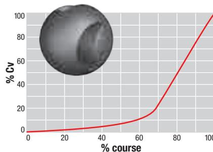
Les fonctions FlexStream permettent de correspondre aux caractéristiques de toute pompe ou courbe de compresseur.
