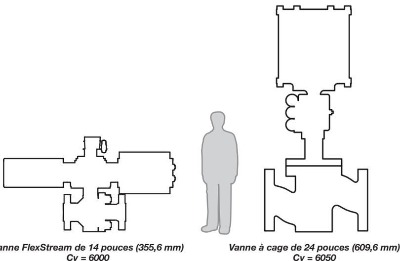
*Comme le démontre cette illustration, le diamètre nominal de la vanne Flexstream est nettement plus petit que celui d'une vanne à cage conventionnelle, tout en garantissant le même coefficient de débit « Cv ».*
